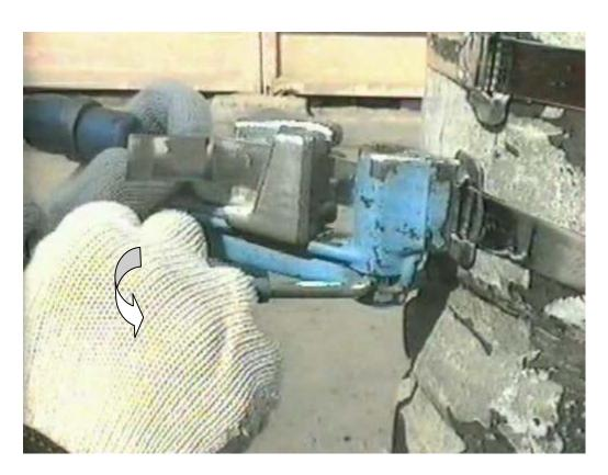
6. Отвести машинку с зажатой лентой на  $180^{\circ}$ , рукояткой 2 обрезать ленту.
