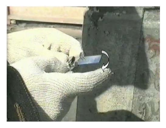
1. Отмерить и отрезать кусок ленты ( $\sim 1$  метр). Вставить конец ленты в скрепу со стороны, противоположной усикам на длину  $\sim 5$  - 7 см.
